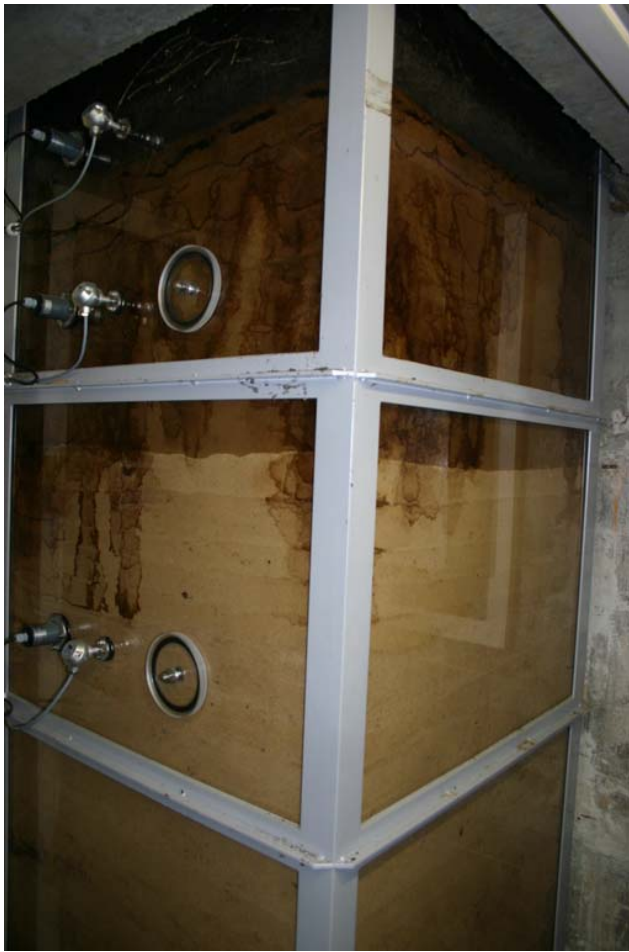
Abb. 4: Lysimeter befüllt mit Finowtaler Sandbraunerde
